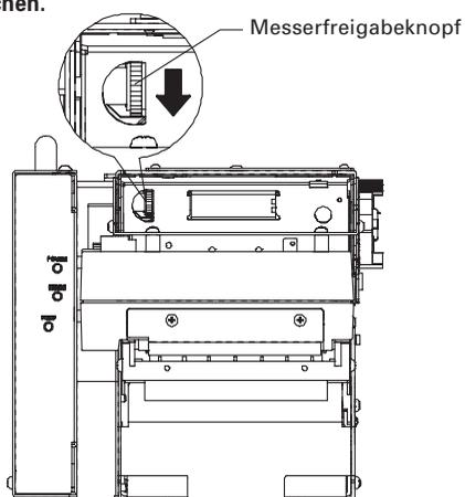
4. Wenn der Steuerkasten getrennt vom Drucker aufgestellt ist, drehen Sie das Kreuzloch in der Abbildung in Pfeilrichtung zum Rücksetzen des Messers.
