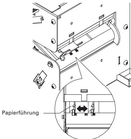
2. Wenn Sie den Papierhalter (PHU-3\*\*\*) verwenden, lösen Sie die Schrauben (4 Stellen einschließlich Gegenseite) wie in der Abbildung gezeigt, stellen den Halter auf die vorgeschriebene Breite ein, und ziehen dann die Schrauben fest. Wenn die Papierbreite 58 mm oder 67 mm beträgt, nehmen Sie den E-Ring ab und bewegen die Papierwalze an dieser Position (1) in der Abbildung.
